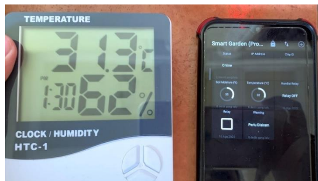
Gambar 5. Pengujian Suhu Udara dengan DHT11 dan Thermohygrometer
