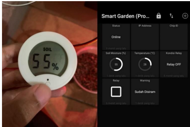
Gambar. 7 Pengujian Sensor Soil dan Soil Meter pada Tanah Basah
