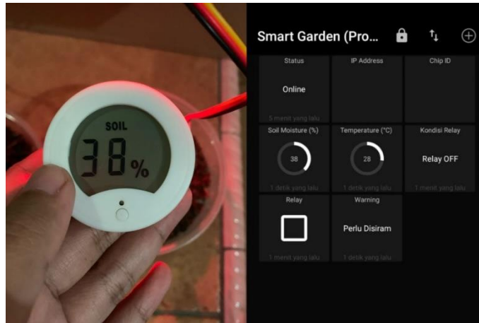
Gambar 6. Pengujian SEN0193 dan Soil Meter pada Tanah Kering
