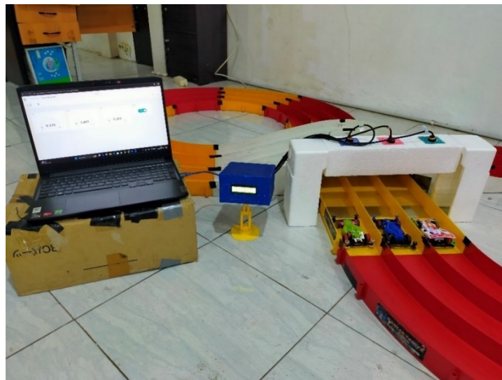
Gambar 6. Implementasi Perancangan Alat pada Lintasan Tamiya
