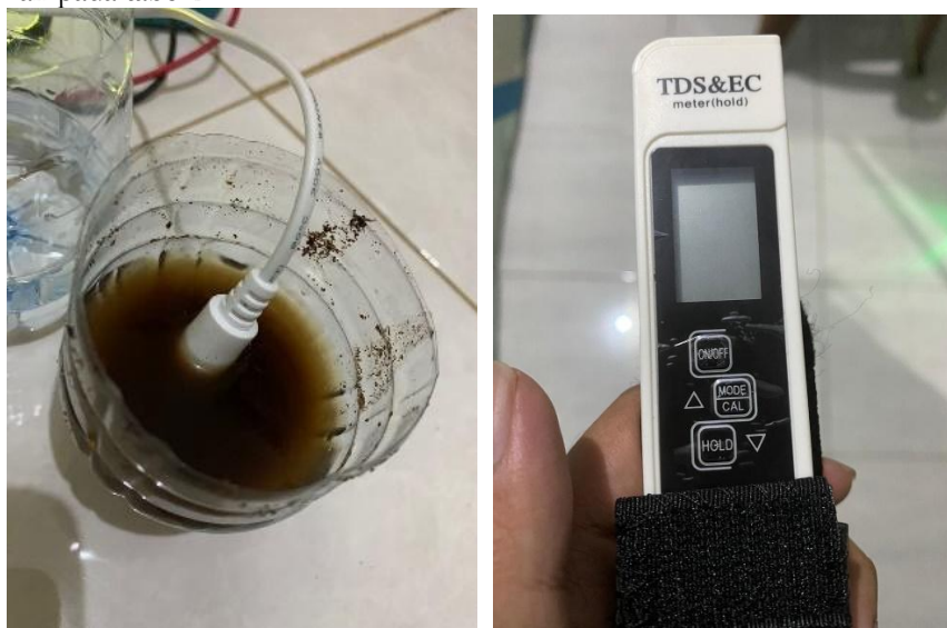
Gambar 5. Pengujian Sensor TDS dengan Larutan Air Kopi
