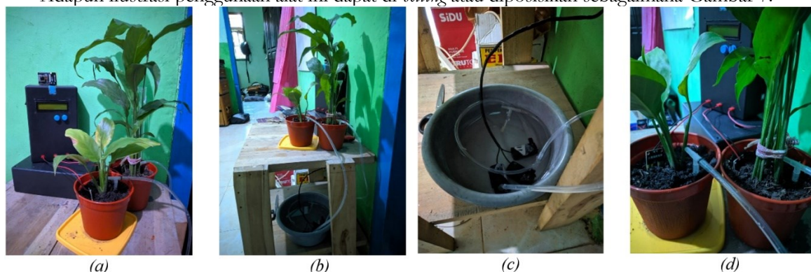
Gambar 7. (a) Peletakan pada meja dengan Tanaman; (b) Jalur selang dari Penampung Air ke Tanaman; (c) Motor pompa pada penampung Air; (d) Peletakan sensor kelembaban dan selang air pada media tanam.
